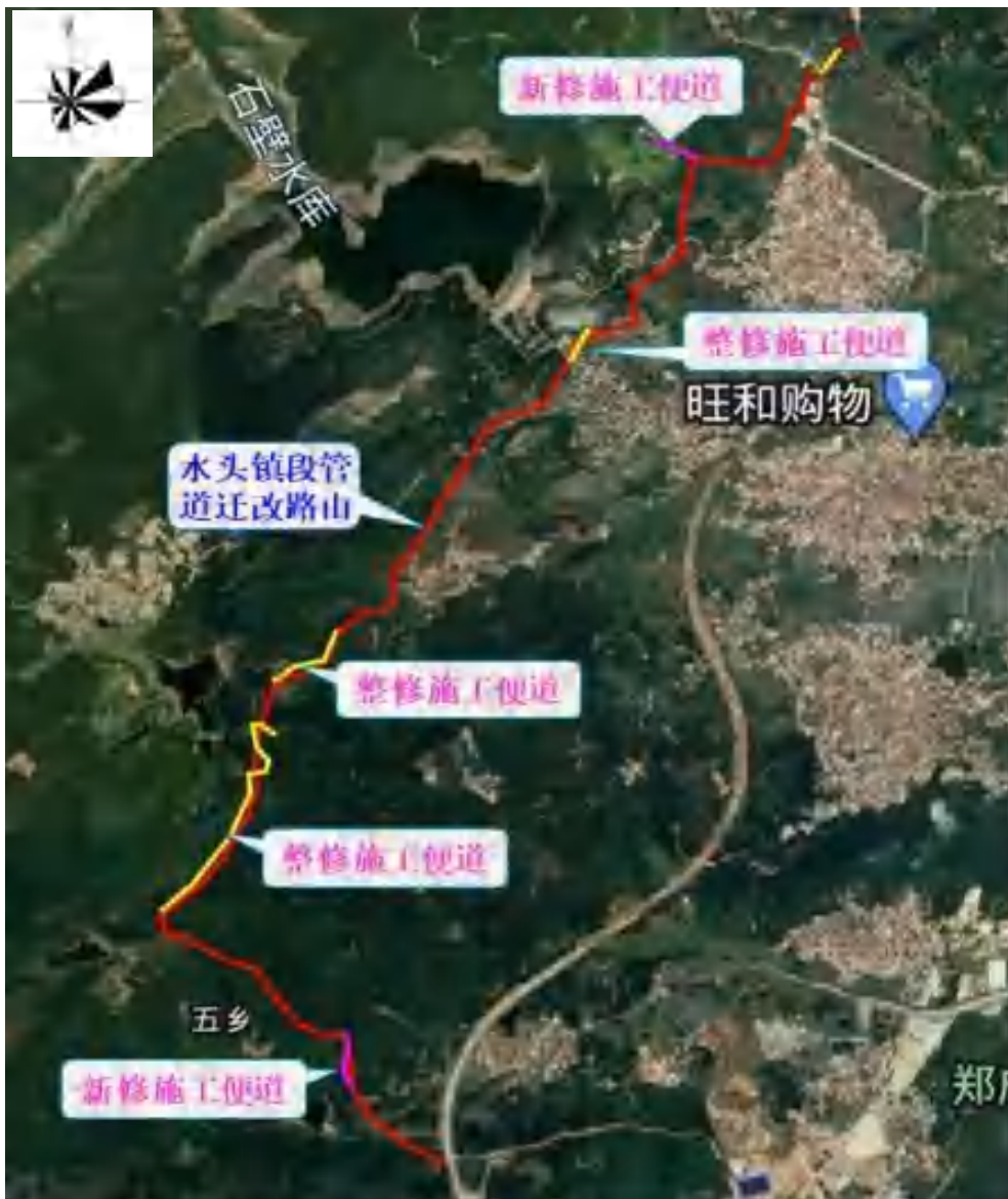
图 3.5-2 水头镇段新修、整修施工便道设置示意图
